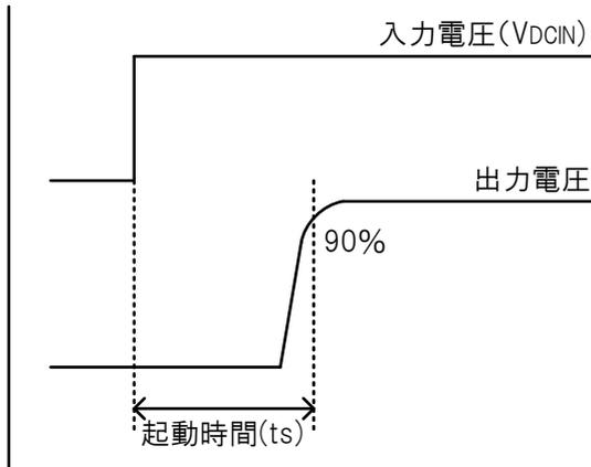
起動時間は、以下のようにコンデンサを外部に接続することにより調整することができます。
