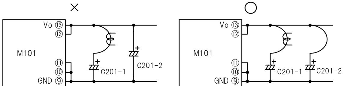
電流測定用リードなどを測定するコンデンサのみに取り付けると、インピーダンスのバランスが崩れ正確な測定ができません。
