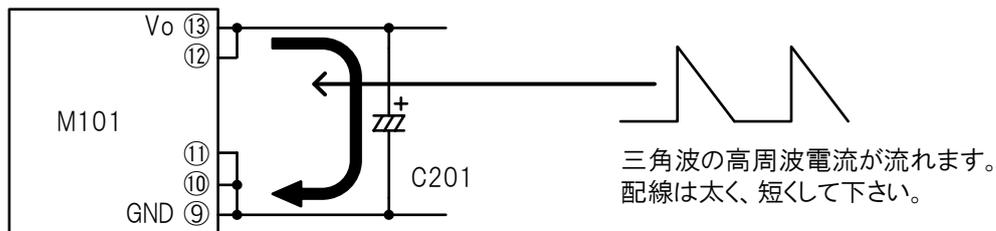
②周波数特性の良い、低インピーダンスの電解コンデンサを使用して下さい。
