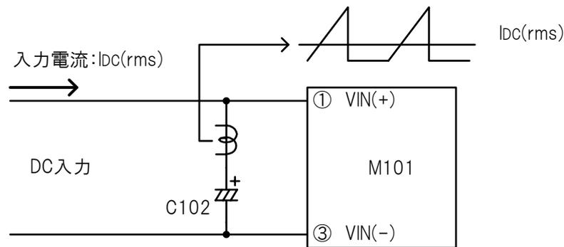
電解コンデンサのリップル電流は、入力電流(DC 電流)を平均値とした三角波の高周波電流となり、リップル電流は以下のように算出します。
