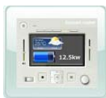
スマートメーター
